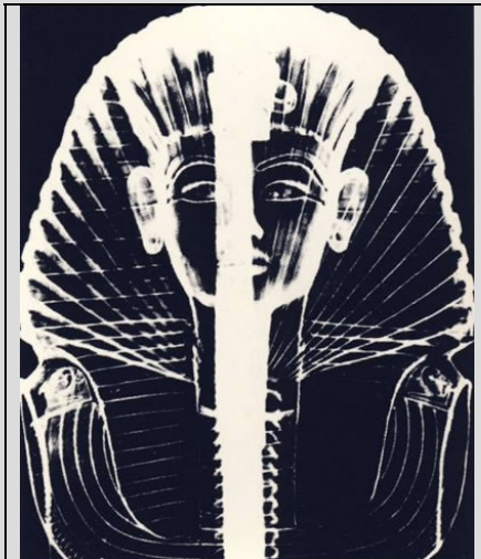
Fig. 5. Radiografía de la máscara de Tutankhamón. Se puede apreciar la uniformidad del grosor del metal, a excepción de una irregularidad en la zona de la mejilla izquierda. Lo más llamativo, no obstante, es que se hace patente que la máscara está integrada por dos partes que se unen en la parte central, surcando el rostro del rey. N. REEVES, Todo Tutankamón. El Rey. La tumba. El tesoro real , Barcelona, 1991, p. 114.
